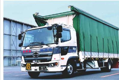
本事業で開発された完全無人トラックによる「最短自動搬送」システムは、走行軌道追従機能を搭載しています。敷地内のマップに走行ルートや停止ポイントなどを設定し、GNSS（衛星情報）による誘導で走行します。
